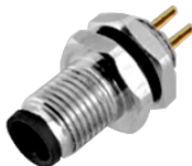
M5 公头面板式，PCB型，后锁安装
