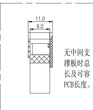
无中间支撑板时总长及可容PCB长度。
